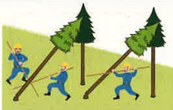
(図2)かかり木の処理
